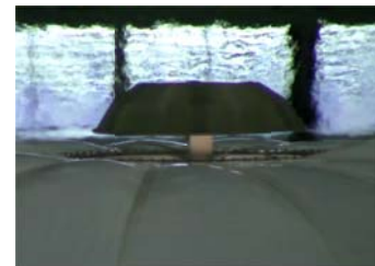
図5 大型排気弁の試験(上)、ヘリウム排気中の大型排気弁(下)
