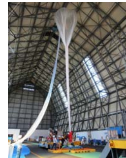
図 12. 気球立て上げの様子
