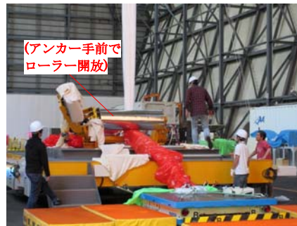
図 11. 子台車による気球立て上げ法
