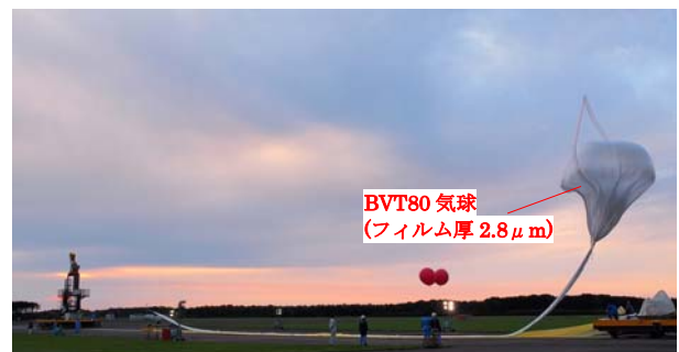
図 9. スライダー放球装置による薄膜気球(BVT80)の放球
