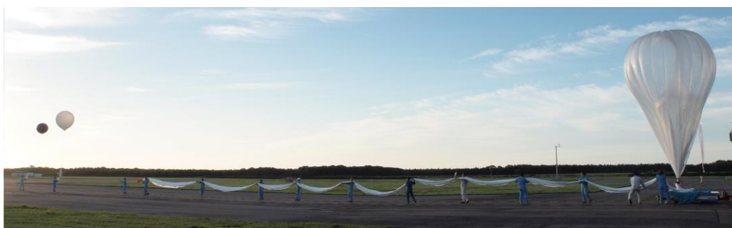
図 1：薄膜型気球放球装置を用いたダイナミックランチング方式
