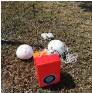
図 1 相乗り放球によるテレメトリー実証試験を行ったペイロード (オレンジ色の筐体)
