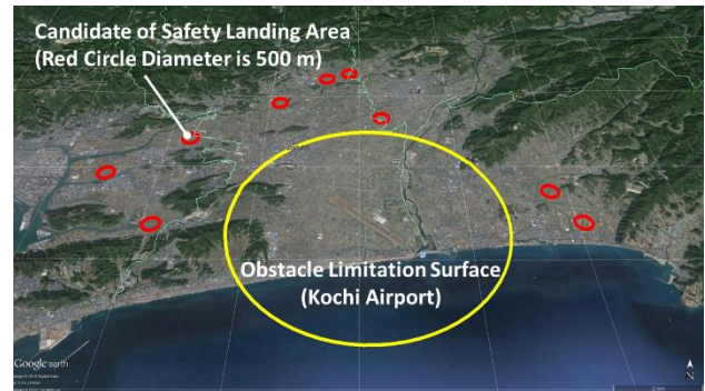
図 6 飛行経路予測に基づいた着地点候補選出のイメージ図
