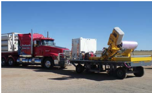
図4: ガストレーラー車に接続されたスプーラー台車
