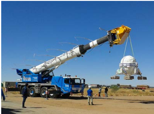
図2: 放球装置を取り付けたクレーン車と GRAINE ペイロード
