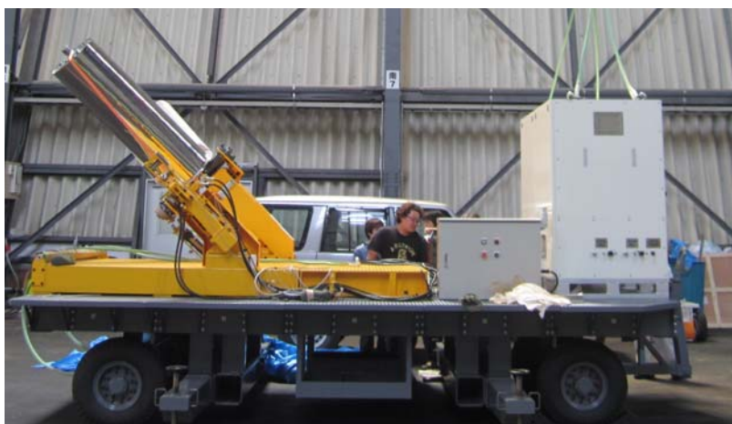
図 3: 豪州用ガス充填装置を放球スプール台車に搭載した状態
