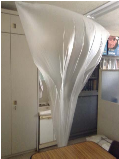
図 1: シリンダー気球によるヘリウムガス漏れ試験の様子。
