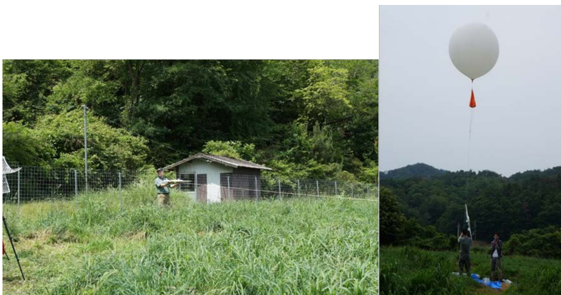
図 2. UAV の離陸の様子. (左)Bungee 法. (右)Balloon 法.
