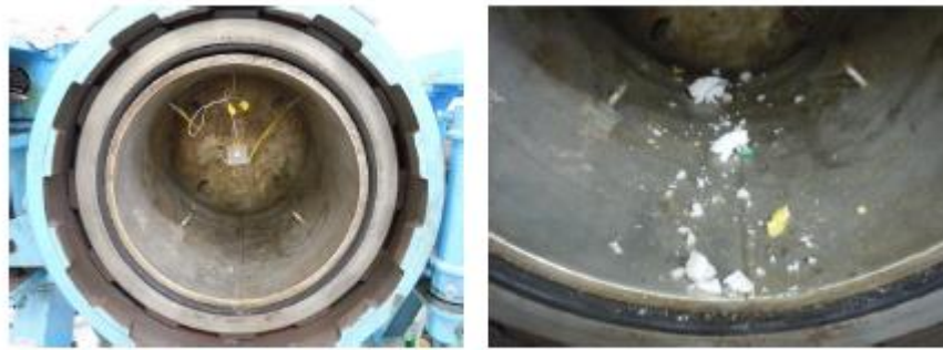
(a) 試験前のチャンバ内・中心が供試体 (b) 試験後のチャンバ内・破砕された供試体 図3 破砕試験実施の様子
