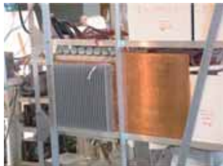
図7 放熱フィンと追加した銅放熱板。最後は、白色塗装した。
