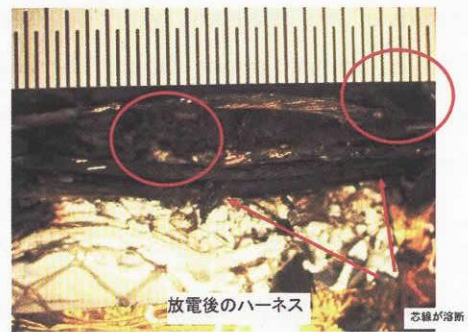
図1 持続放電後の電力ハーネス
