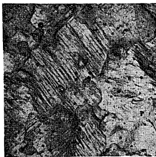
写真 2 疲労により生じた向き線
