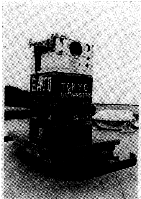
図-1 ゴンドラを乗せた放球台車
