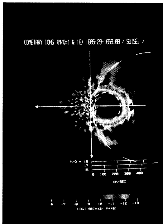
図8 衝撃波の外側で観測されたイオンの速度分布関数。 小さい破線円と大きい破線円は、それぞれ、彗星起源の H^+ 及び O^+ のピックアップ・シェルの理論的な出現位置を示す。
