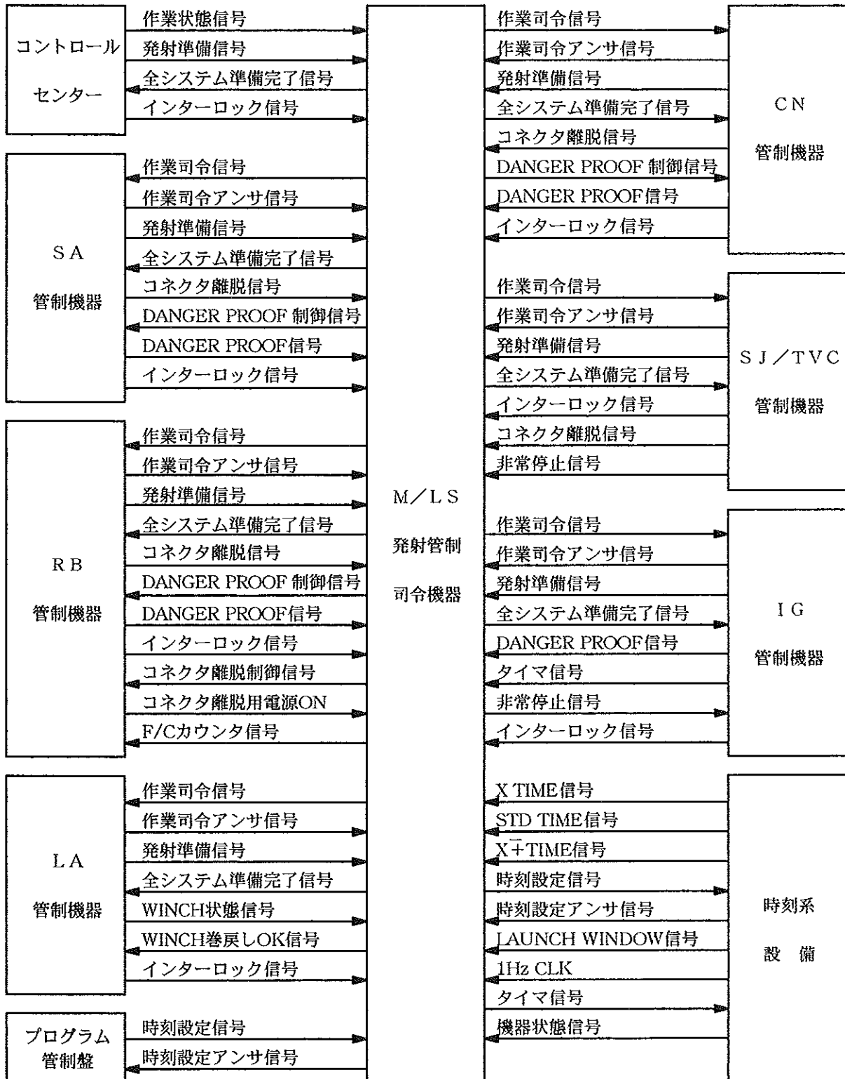
図2.1 M/LS 発射管性司令装置インターフェース系統図
