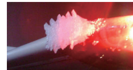
実機主翼の翼端部への着氷事例 (防水部は着氷していない) Jack Lampe, "Rime Ice in O'Hare", SAE2011
