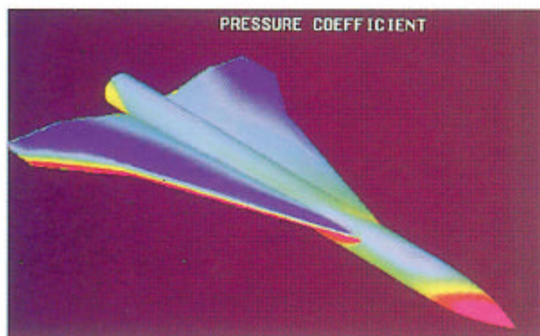
図4 機体上面圧力分布-風上側 (ケース9)
