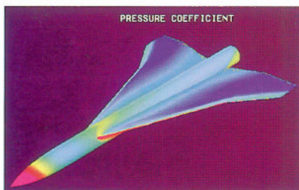
図2 機体上面圧力分布 (ケース7)
