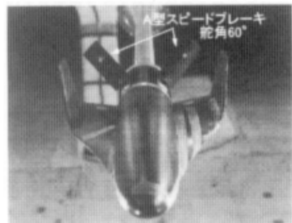
図1 A型SBを舵角 60^\circ で取り付けられた風洞内模型 風試での風速は主に 40\text{m/s} とした。このときのレイノルズ数は約 0.8 \times 10^6 (空力平均翼弦長基準)になる。流れの可視化でのオイルフローの成分は二酸化チタン、流動パラフィン(主に)、オレイン酸を用いた。
