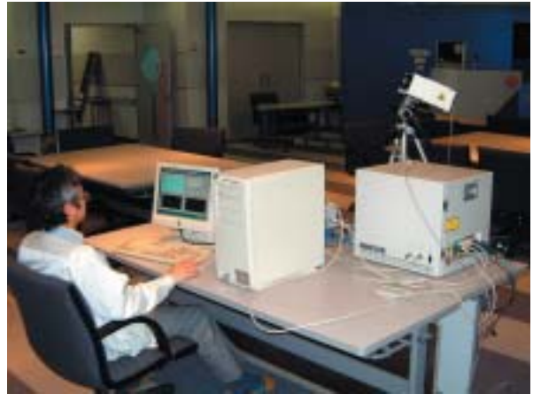
図3 風計測ライダ試験装置
