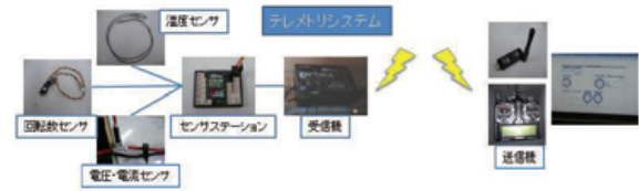
図6 テレメトリシステム概要図
