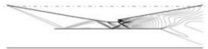
図11 カウルを長くした場合の圧力分布 (マッハ4)
