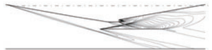
図12 カウルを短くした場合の圧力分布 (マッハ7)
