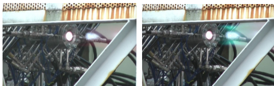
図4 試験中の火炎の様子 ( P_c = 3 \text{ MPa} , M = 4.8 ) (左) フィルム噴射前、(右) フィルム噴射後
