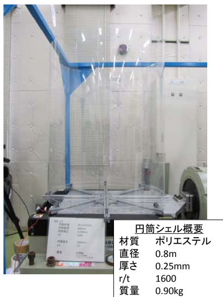
図 10 大型円筒シェルの振動試験(座屈試験)
