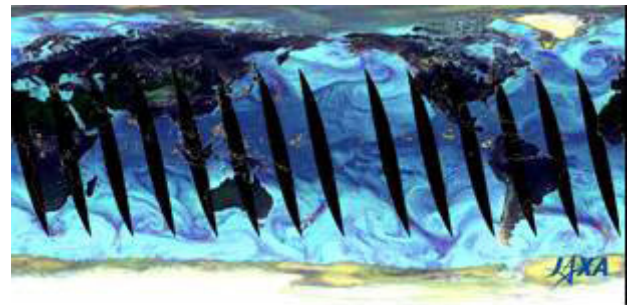
図 5 GCOM-W1 初画像の例（89GHz 垂直・水平偏波、23GHz 垂直偏波の輝度温度データを合成した画像）
