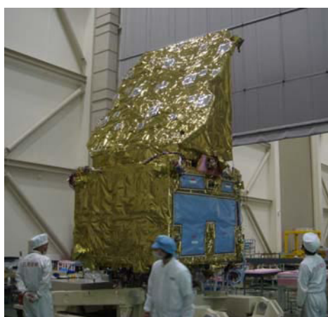
図 4 ALOS-2 衛星外観 (SAR アンテナ、太陽電池パドルを取り外した状態)
