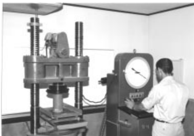
図14 コンクリート圧縮強度試験
