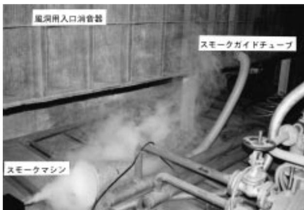
図 17 散乱粒子としてのスモークの流入方法
