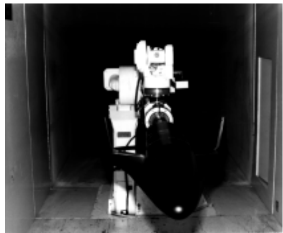
図2 風洞内でロボット型模型支持装置に装着された模型
