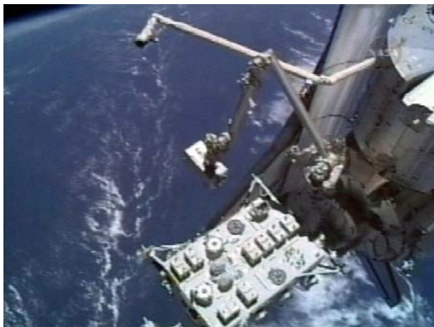
第2図 ペイロード移設中の JEMRMS
