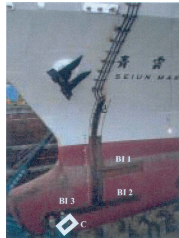
図 1 船首部に取り付けられた気泡発生装置 2)
