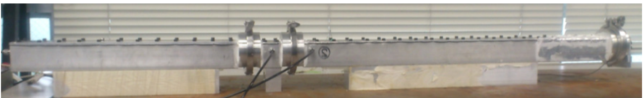
図 1: 衝撃波管(PSP の時間応答性評価時)
