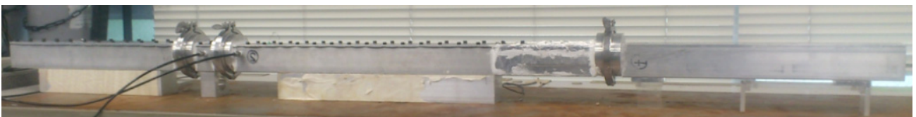
図 2: 衝撃波管(PSP の非定常流れへの適用時)
