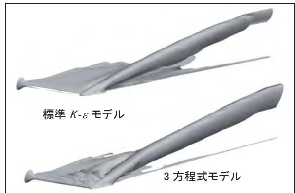
図10 翼端渦の遠方での減衰具合の比較（ \alpha=10^\circ ） （渦度（ |\Omega|=0.5 ）の等値面を表示）
