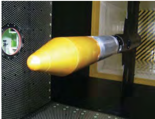
図5 遷音速風洞に取りつけられた風洞模型 (クリーン形状)
