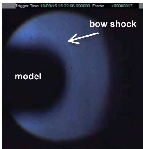
図7 模型前方の弓型衝撃波
