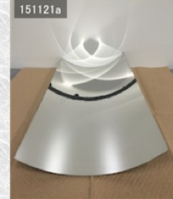
Figure 1-2. レプリカ法でPtを成膜したCFRP製反射鏡基板サンプル(基板ID: 151121a)。
