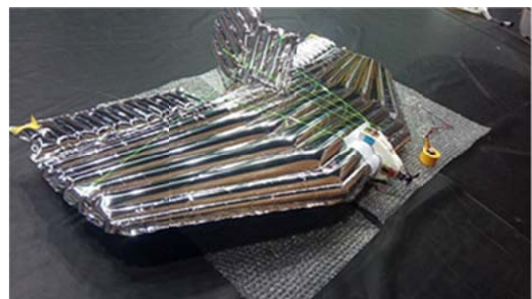
図2. 仕切り型オールインフレータブル飛行機
