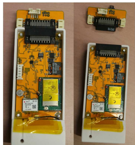
図 5 メインモジュール完成写真
