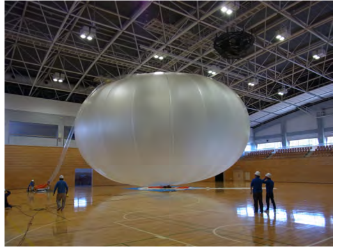
図 2: 体積 2,000 m 3 の気球 (NPB2-2) の正常展開。
