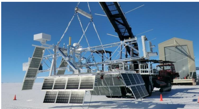
図 1: X-Calibur 気球の全体写真。2018 年 12 月の南極フライトで利用。全長~8m。左: 偏光計、右: 硬 X 線望遠鏡。次回 2021 年のフライトでは日本から FFAST 衛星用の硬 X 線望遠鏡を提供する。焦点距離が 12m なので、ゴンドラも長くなる。
