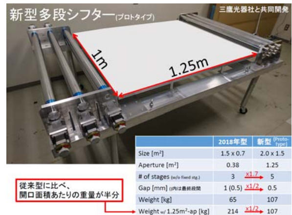
図4: 新型ローラー式多段シフター
