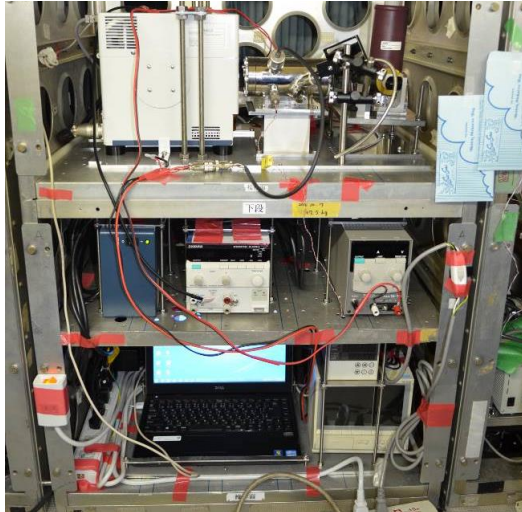
図 4. 航空機実験用の浮遊ダスト赤外線吸収スペクトル測定装置。上段左から光源、チェンバー、放射温度計、検出器の順に並んでいる。中段は電源、下段は制御用 PC とデータロガーが配置されている。
