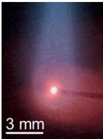
図 1. ガス中蒸発法の 1 例。タングステンを酸素 2000 Pa とアルゴン 38000 Pa の混合ガス中で加熱蒸発させた様子。中央の輝点が蒸発源。
