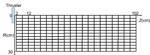
図 7 プルーム電位測定点 (格子点). R および Z 方向測定点間隔はそれぞれ 2.5cm および 5.0cm.
