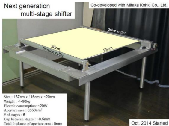
図 3.ローラ駆動型多段シフター単段型プロトタイプ
