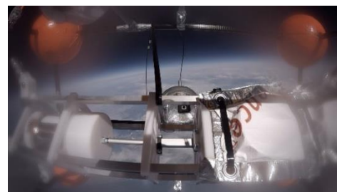
図 3 成層圏におけるバイオエアロゾルサンプラー
