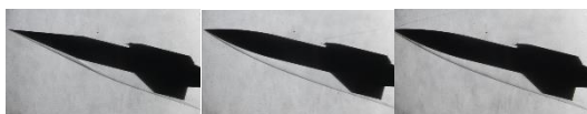
図9 迎角-15deg付近でのシュリーレン画像 (左:円錐, 中央:オジャイブ, 右:パラボリック)
