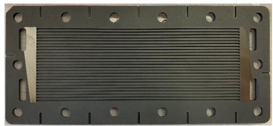
図 5 St型セパレータ
