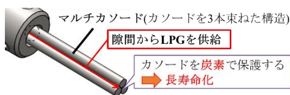
図1 電極保護用のLPGの供給方法
