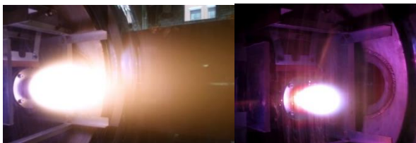
図15 アンモニア (左) と水素 (右) 推進剤の 大電力アークジェット噴射写真
