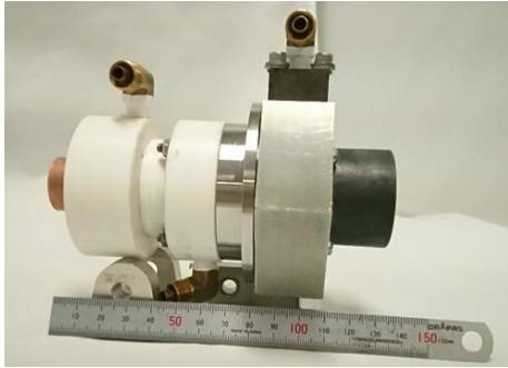
図2 アノード輻射冷却式アークジェットスラスタ本体写真
