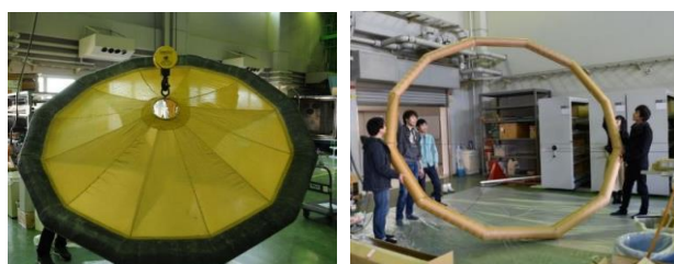
図 8 これまでに試作した大型のエアロシェル (左、直径 2.5 m) とインフレーターブルリング (右、直径 3.5 m)
