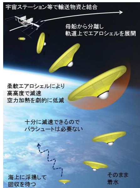
図 1 展開型エアロシェルを利用した地球低軌道からの帰還
