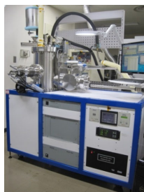
アウトガスレート試験装置 6)
